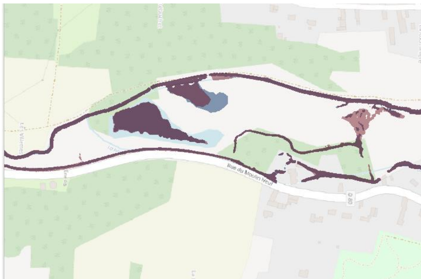
Figure 2. Zones inondées après 1h40 de simulation dans le scénario 2.1 (bleu) et sa variante (rouge)
