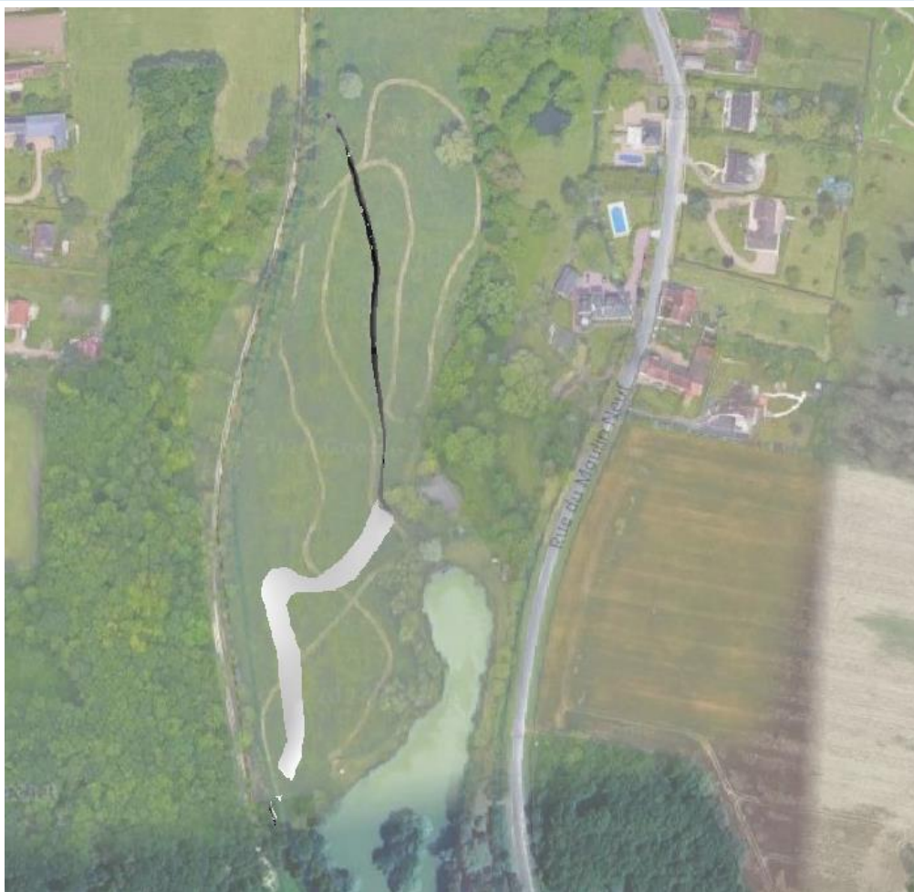
Figure 67. Reconnexion du lit ancien du ruisseau avec le ruisseau actuel par un chenal à 62.25m NGF d'altitude.
