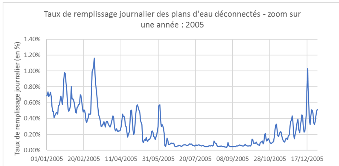
Figure 51 : BV Fouzon - Taux de remplissage journalier en fonction du temps des plans d'eau déconnectés sur l'ensemble du bassin (Sources : AELB, Météo France, Suez Consulting 2020)
